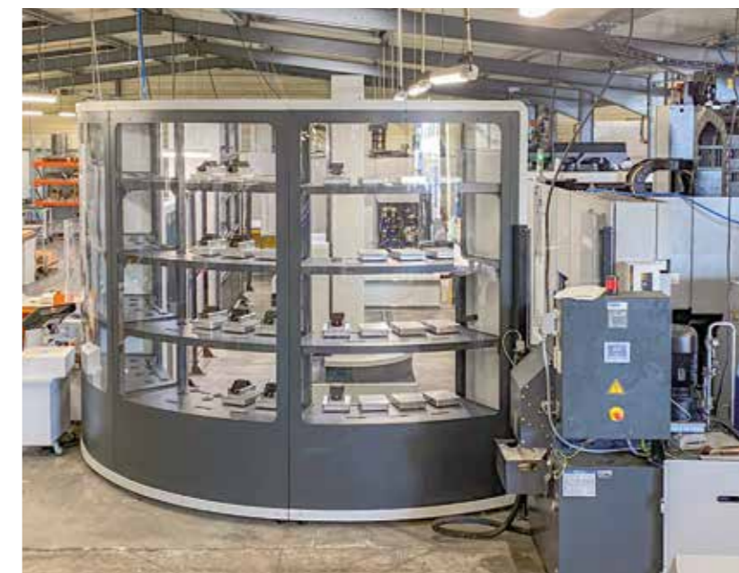
Le robot Engineering Data L250 pourra alimenter jusqu'à 6 centres d'usinage. Il alimente actuellement 3 centres d'usinage 5 axes : le NMV 3000, le NMV 5000 et le Mazak CV5-500.
